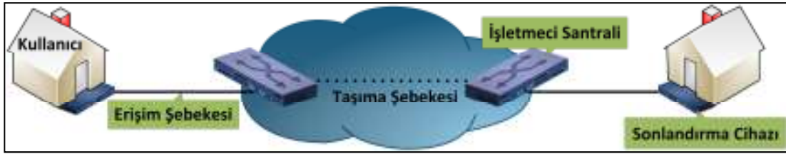
Şekil 1: Geleneksel Kiralık Devre Topolojisi
