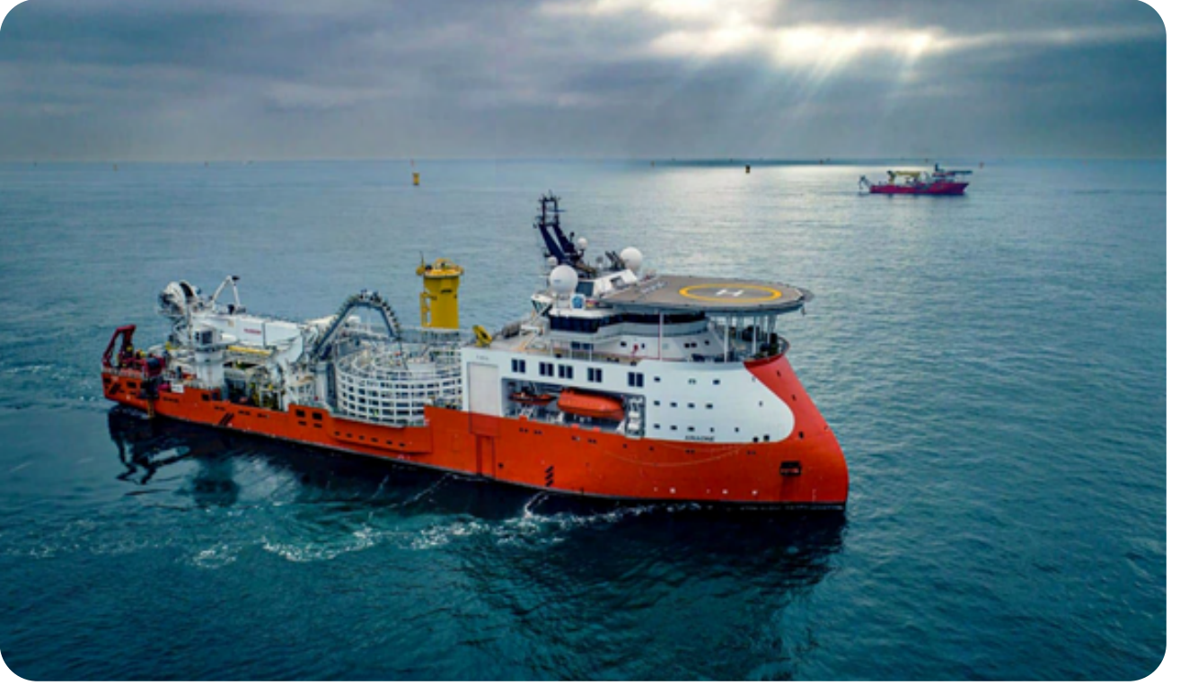
Şekil 5. Ariadne İsimli Kablo Döşeme Gemisi
