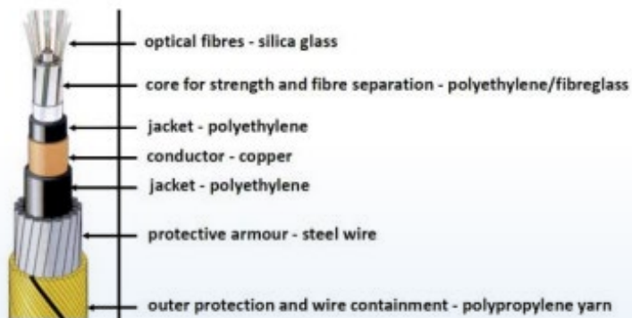
Şekil-3: Modern Denizaltı Kablosunun İçeriği
