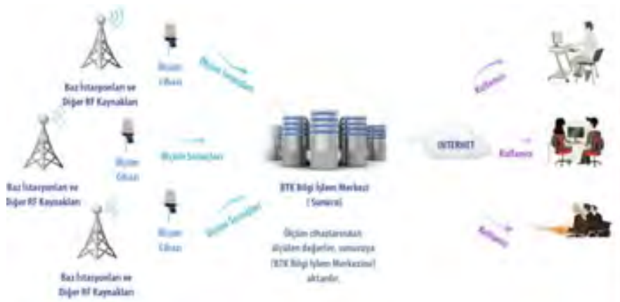
Şekil 45: Elektromanyetik Alanları Sürekli İzleme Sisteminin İşleyişi
