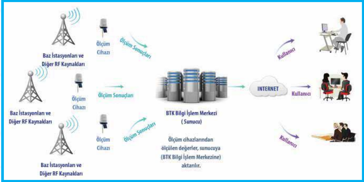
Şekil 48: Elektromanyetik Alanları Sürekli İzleme Sisteminin İşleyişi
